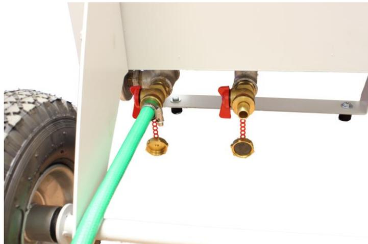
Abb. 9): Wasserzuleitung am KFE-Anschluss des **Heizungs-
