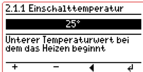
Durch Drücken der Taste unter der Anzeige „+“ kann die Einschalttemperatur erhöht (oder mit der Taste „-“ gesenkt) werden.
