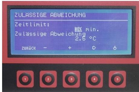
Bei dieser Betriebsart läuft das Programm in Temperaturstufen ab. Wenn eine neue Temperatur vorgegeben wird, kann es einige Zeit dauern, bis die mobile Heizzentrale das System auf die neue Temperatur aufgeheizt hat. Im ersten Menüpunkt geben Sie ein, nach welcher Zeit die Abweichung von der Solltemperatur kleiner als der eingegebene Wert sein muss. Ist dies nicht der Fall, wird eine Warnung angezeigt, die aber keinen Einfluss auf das aktuell laufende Programm hat.
