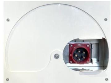
Beim EH22P3 sind die drei Möglichkeiten 230V/16A~ (max. 3,5 kW), 400V 3N~/16A (max. 11 kW) und 400V 3N~/32A (max. 22 kW). Wählen Sie den richtigen Anschluss für die Stromversorgung über die drehbare Blende an der Geräteseite aus und schließen Sie die Stromversorgungsleitung an die mobile Elektroheizzentrale an.
