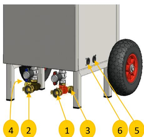
Schließen Sie die **Verbindungsleitungen** für Vorlauf (1) und Rücklauf (2) sowie einen Füll- (4) und Entleerungsschlauch (3) an die dafür vorgesehenen Anschlüsse am Gerät an. Stellen Sie sicher, dass austretendes Wasser abfließen kann. Schließen Sie **die mobile Elektroheizzentrale mit Trinkwarmwasseroption\*** zusätzlich an Warm- und Kaltwasser (5 und 6) an.
