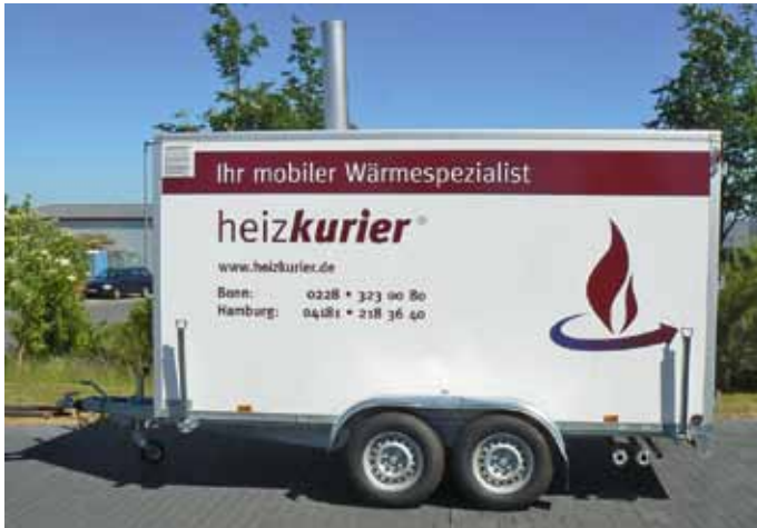
„Öl-heizkurier“ mit 150 kW.
